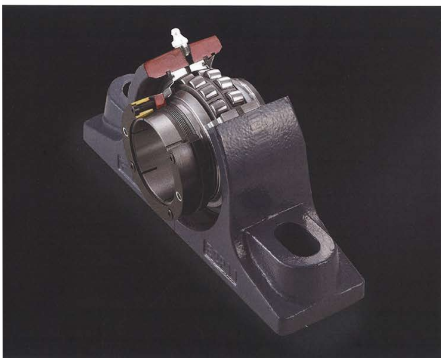
Die SRU-Lagereinheiten bestehen aus einem robusten und hoch belastbaren Pendelrollenlager sowie einem Gehäuse aus hochfestem Gusseisen (GGG). Bilder: Findling
