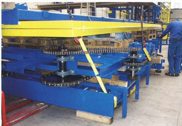
◀ Durch die verstärkte Basis der Xforce-Gehäuselager ist das Gehäuse wesentlich unempfindlicher gegen Bruch, die Belastbarkeit erhöht sich um ein Vielfaches
