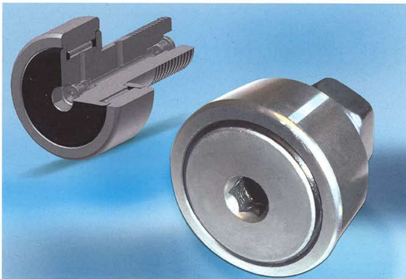
Im Sortiment von Findling Wälzlager finden sich auch robuste Kurvenrollen, die eine Sonderform der Nadellager darstellen; im Bild eine oberflächenbeschichtete Ausführung, die 96 Stunden im Salzsprühnebeltest besteht
