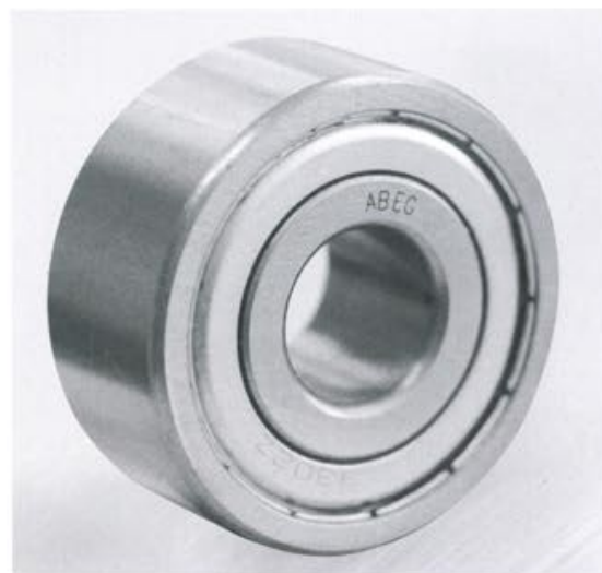
Schräggugellager sind eine gute Wahl für die Leichtlaufrollen von OP-Tischen: Durch ihre innere Geometrie lassen sich sehr steife und spielfreie Lagerungen realisieren.
