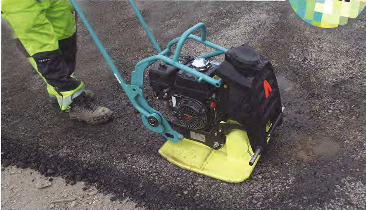
Generalprobe bestanden: Ammann verbaute die Lager von Findling erst nach einem Dauertest von gut 1000 Stunden in die neuen Rüttelplatten.
