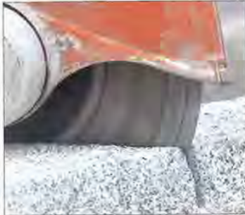
Beim Betrieb der Blocksteinsäge entstehen Hitze oder Abkühlung, Staub, Schlamm, Vibrationen und Stöße – entsprechend robust muss die Lagertechnik ausgelegt sein.
