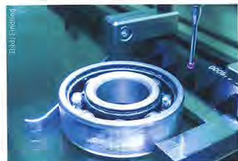
Die visuelle Untersuchung von schadhaften Rillenkugellagern erbringt wertvolle Hinweise, im vorliegenden Fall sind Schleifspuren am Außenring sowie Passungsrost am Innenring zu erkennen.
