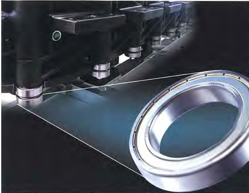
Abb. 2: Die Verbindung der Backzangenkette erfolgt mittels gehärteten Stahlwellen; als Laufrollen dienen jeweils zwei der besonders temperaturbeständigen Xtemp-Rillenkugellager.
