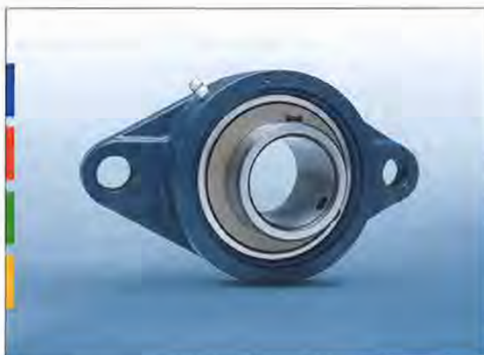
Beim Zweiloch-Flanschlager des Typs UCFL-206 werden die Wellen mit zwei Madenschrauben am Lagereinsatz befestigt, somit ist bei Bedarf ein unkomplizierter Austausch der Lager gewährleistet. Bild: Findling Wälzlager
