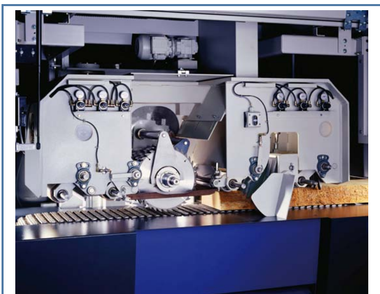
ABEG-Gehäuselager von Findling Wälzlager in der Vielblattkreissäge ProfiRip KR310 von Raimann
