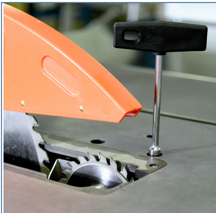
Die Formatkreissägen der Forsa-Serie sind mit einem separat zuschaltbaren Vorritzer mit eigenem Antrieb lieferbar
